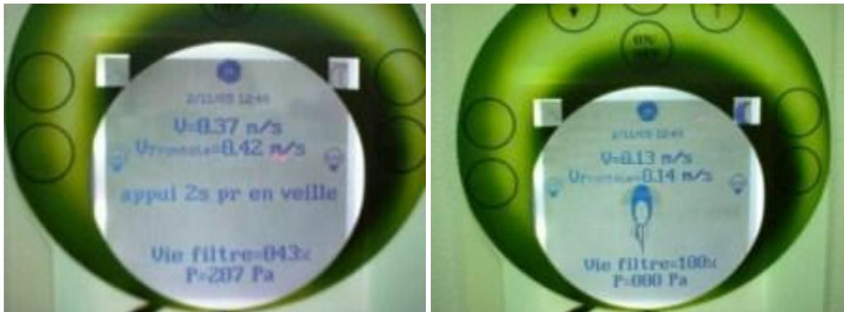
Lorsque la hotte revient au mode normal, la visière reste fermée jusqu'à ce que le flux atteigne sa vitesse minimale. Alors, la visière s'ouvre automatiquement jusqu'à la hauteur normalisée.
