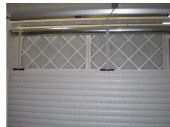
**Filtre de soufflage :** Accès par le volume de travail, desserrer les vis de serrage du filtre, démonter la cornière avant, et déposer le filtre HEPA. Poser le neuf en faisant l'opération inverse.
