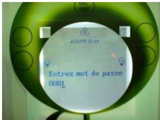
Le mot de passe pré-réglé en usine est "0001". Il est modifiable dans le Menu.
