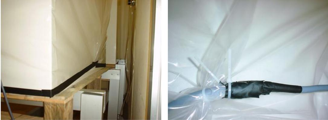
5. Rebrancher le Poste de Sécurité Microbiologique. Le cycle de fumigation commence. Ce cycle peut se faire PSM éteint ou PSM allumé en mode « Veille ». Dans le cas où on choisit de laisser le PSM éteint, il est préférable de faire tourner le ventilateur 10 à 15s au bout de ½ heure à 1heure de fumigation puis encore 10 à 15s au bout de 2 heures de fumigation. La décontamination doit durer au moins 8h pour être efficace.
