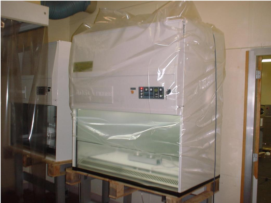
7. A l'issue de la neutralisation, on peut retirer le plastique du poste en prenant bien soin de prendre des gants de protection et d'ouvrir au maximum les fenêtres ou aérations du local. Laisser le poste s'aérer 1 heure puis procéder à un nettoyage des surfaces avant de travailler à nouveau dessous.
