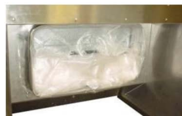
3) Mise en place du sac neuf
