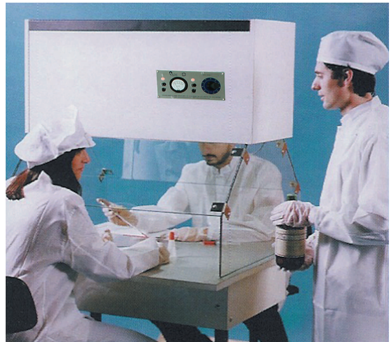
Poste en vis-à-vis MV
