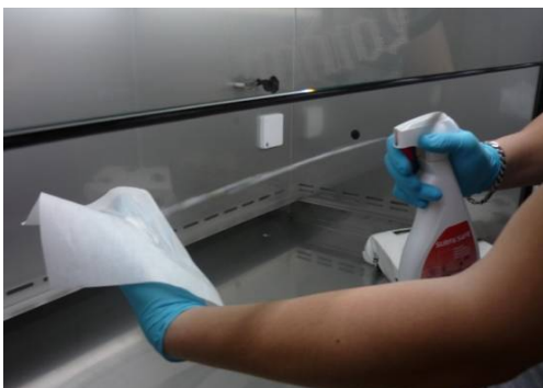
Pulvériser un produit désinfectant sur un tissu propre, préconisé pour le nettoyage de PSM. Il est déconseillé de pulvériser le produit directement sur le plan de travail et les parois.
