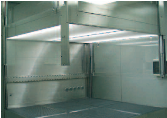
Cabine avec reprise par plan de travail perforé
