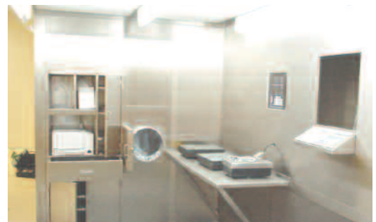
Cabine intégrant un système informatique de pesée Niche Informatique et table pour pesée fine. Industrie Pharmaceutique
