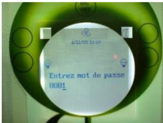
Le mot de passe préreglé en usine est "0001". Il est modifiable dans le Menu. La présence d'un mot de passe est obligatoire sur les PSM.
