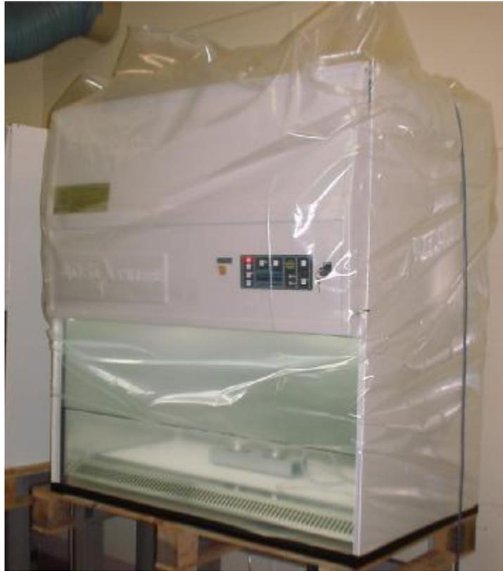
6. A l'issu de la neutralisation, on peut retirer le plastique du poste en prenant bien soin de prendre des gants de protection et d'ouvrir au maximum les fenêtres ou aérations du local. Laisser le poste s'aérer 1 heure avant de procéder aux opérations de maintenance nécessaires.
