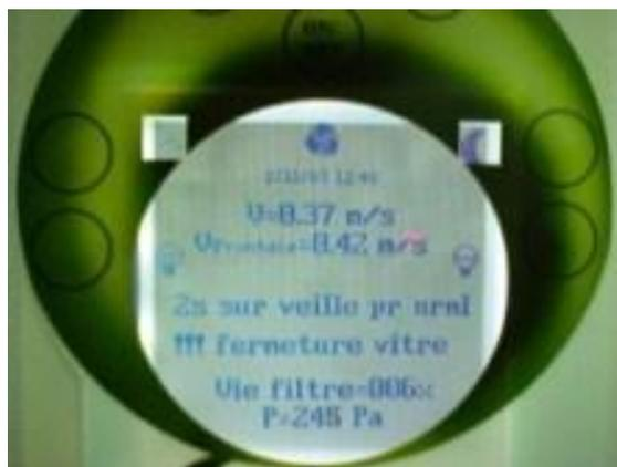
La vitesse du flux diminue et la lumière s'éteint. En mode veille, il est possible de rallumer l'éclairage au besoin.
